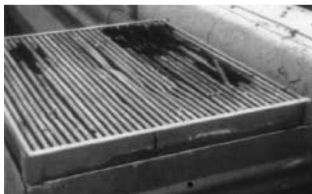
**Figura 6: Separador de gotas semidestruido por la corrosion**
